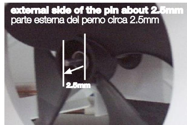
**Dismounting procedure - Procedure di smontaggio - GO43NFH**
