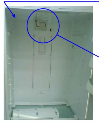
Cablaggio Damper schiumato: il cablaggio è presente solo nelle versioni display e 3 led. (la versione 5 léd prevede invece un diffusore in polistirolo senza damper)
