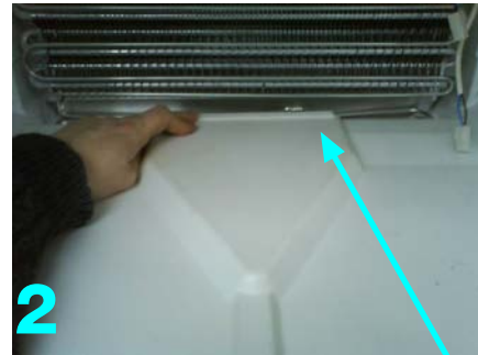
Installation position for new plastic air conveyer posizione di installazione del nuovo convogliatore in plastica
