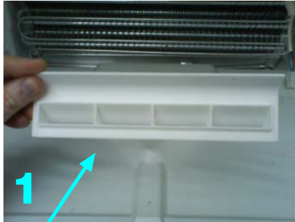
new plastic air conveyer Nuovo convogliatore in plastica
