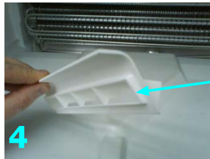
Installation position for new plastic air conveyer posizione di installazione del nuovo convogliatore in plastica
