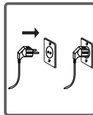
Предохранитель, установленный на линии электропроводки, на которой стоит розетка для подключения машины, также должен быть рассчитан на 10 ампер. При отсутствии в вашей домашней электропроводке розетки и предохранителя такого типа обеспечьте их установку и подключение, обратившись к квалифицированному электрику.
