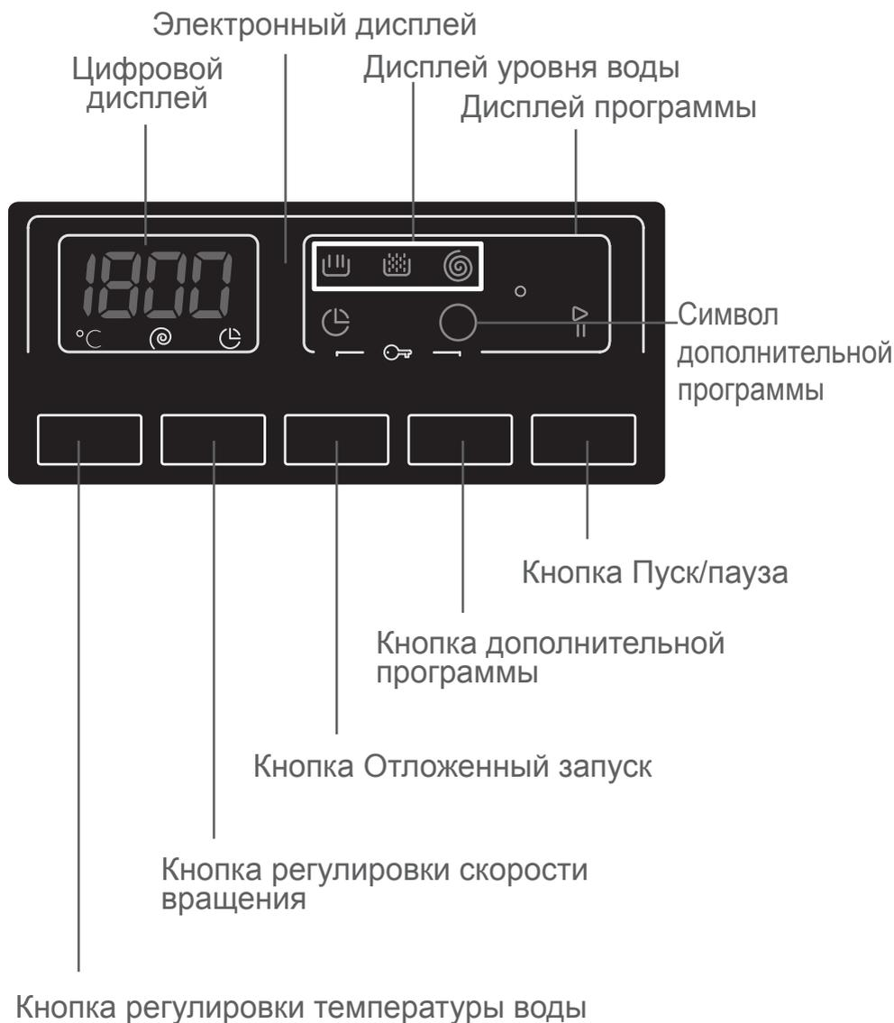
На электронном дисплее вы можете увидеть температуру воды, скорость отжима, время окончания стирки, выбранные дополнительные программы и этап выбранной программы (☰ → предварительная стирка/стирка, ☰ → полоскание, ☰ → отжим).
